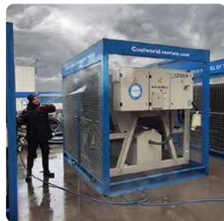
Reinigung mit Hochdruckreiniger
